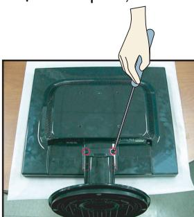
3. Установка пластины для настенного крепления.
